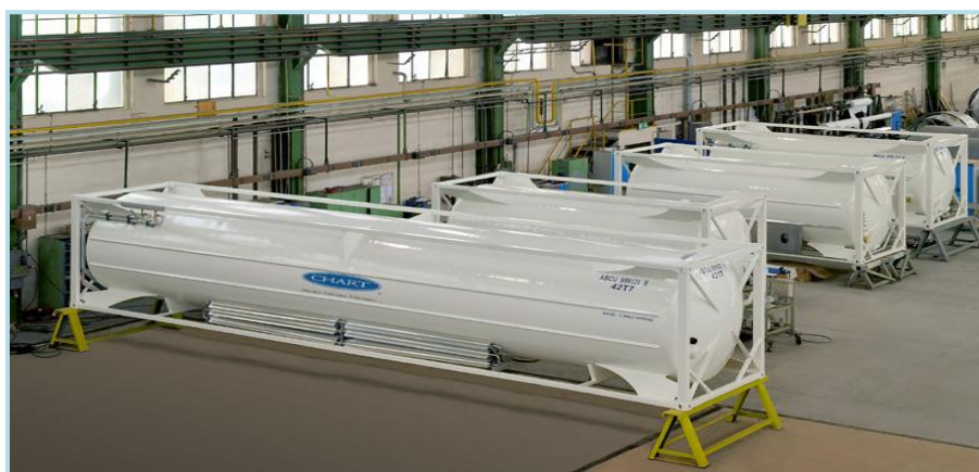
4-3. 40 feet LNG container. Source Chart
