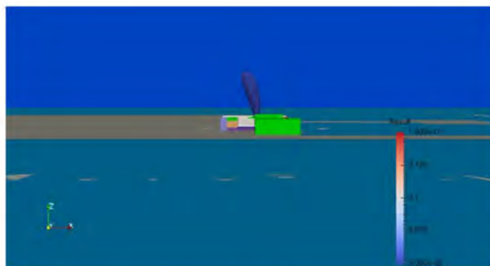
Ilustración 2.5: Alzado fuga vertical, dentro de los límites de inflamabilidad (0.05 - 0.15), diámetro 40 mm y viento de N-NE.
