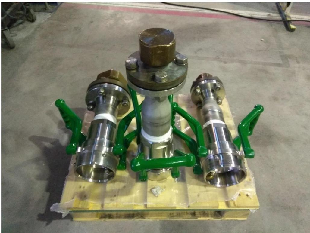
*Figura 84 Acoples Mantekk utilizados*
