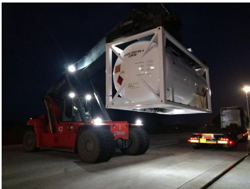
*Figura 64 Grúa Reach Stacker para posicionar el isocontenedor en el vagón asignado*
