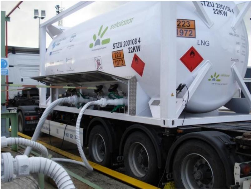
Figura 57 Procedimiento de carga de GNL
