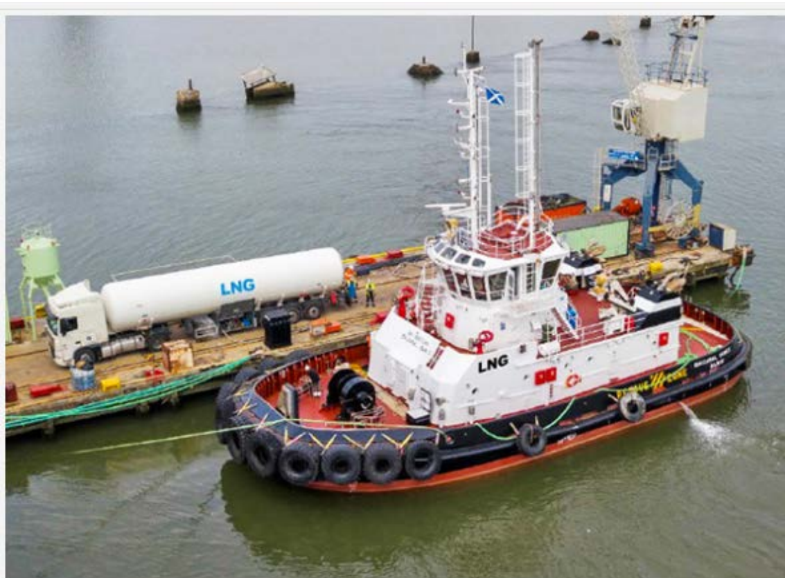
Imagen de la operativa del bunkering de "Ibaizabal Quince" en el puerto de Bilbao por parte de Molgas Energía.
