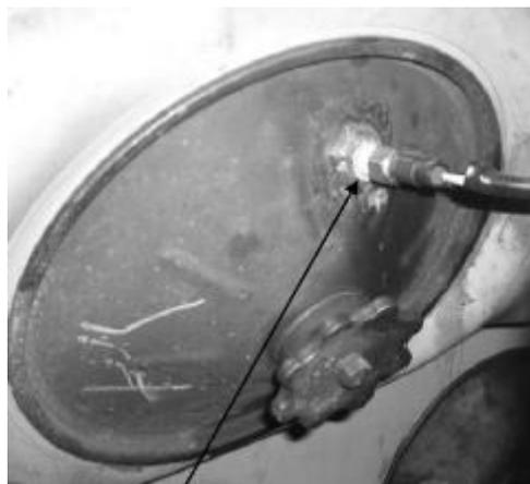
**Figura 164. Sensor de temperatura de la caja de aire**
