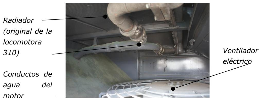
**Figura 105 Sistema de refrigeración**
