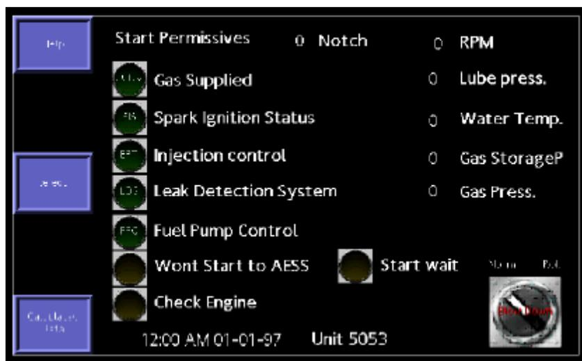
**Figura 113 Pantalla del sistema de control del motor**
