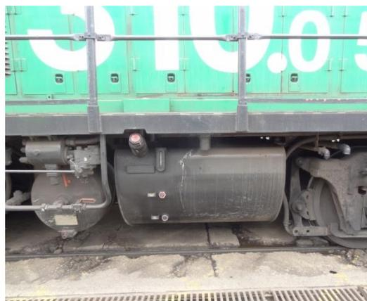
*Depósito de gasóleo – Locomotora
