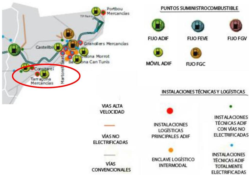
Figura 7. Puntos de suministro de combustible e instalaciones técnicas y logísticas. Fuente: Adif (2015).
