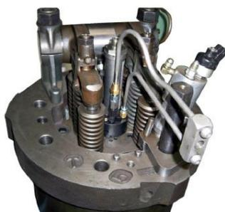
*Instalación del Inyector
