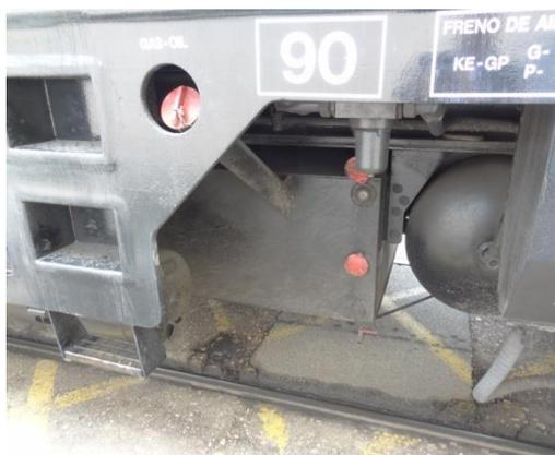
*Depósito de gasóleo – Locomotora
