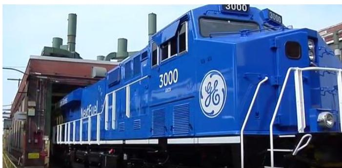
**Figura 69. Sistema Dual con GNL desarrollado por General Electric (NextFuel™ Natural Gas Retrofit)**
