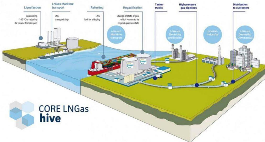
Liquefação – refrigeração do gás a -160 °C com vista a reduzir o volume para transporte
