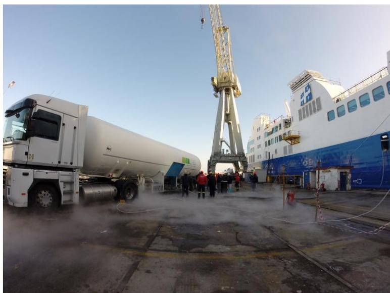
Ilustración 2: suministro GNL mediante TTS
