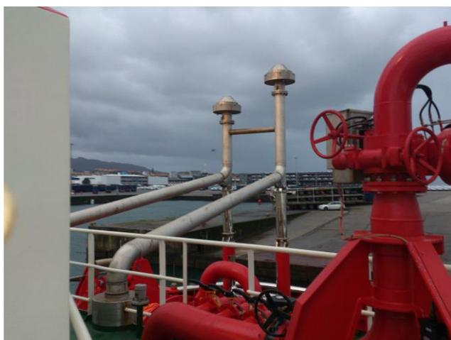
Ilustración 1: Venteo tanques buque receptor
