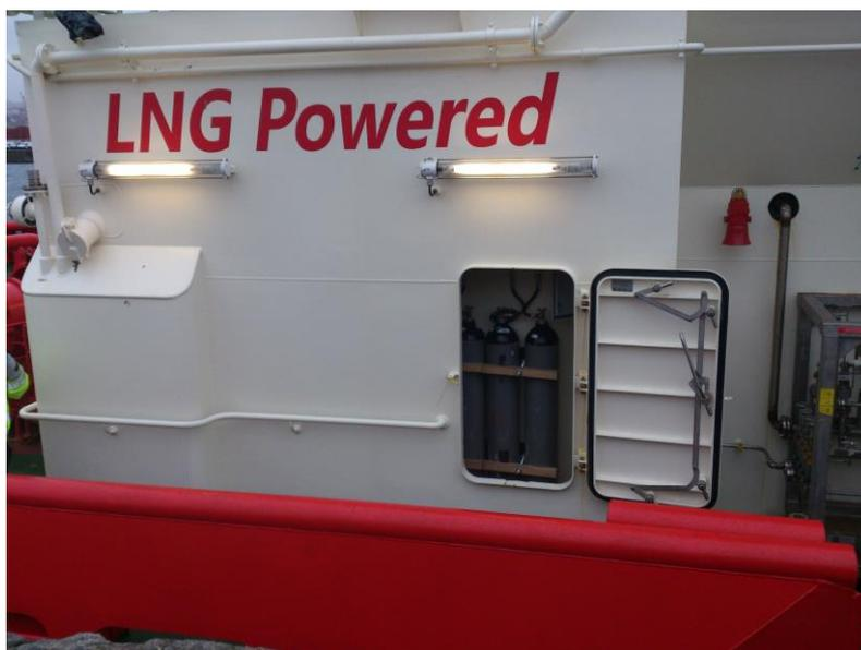
Ilustración 12: Botellas de Nitrógeno buque
